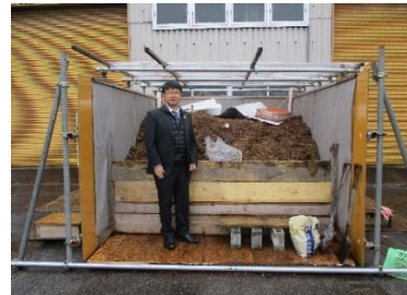
堆肥の熱を利用した発酵槽
